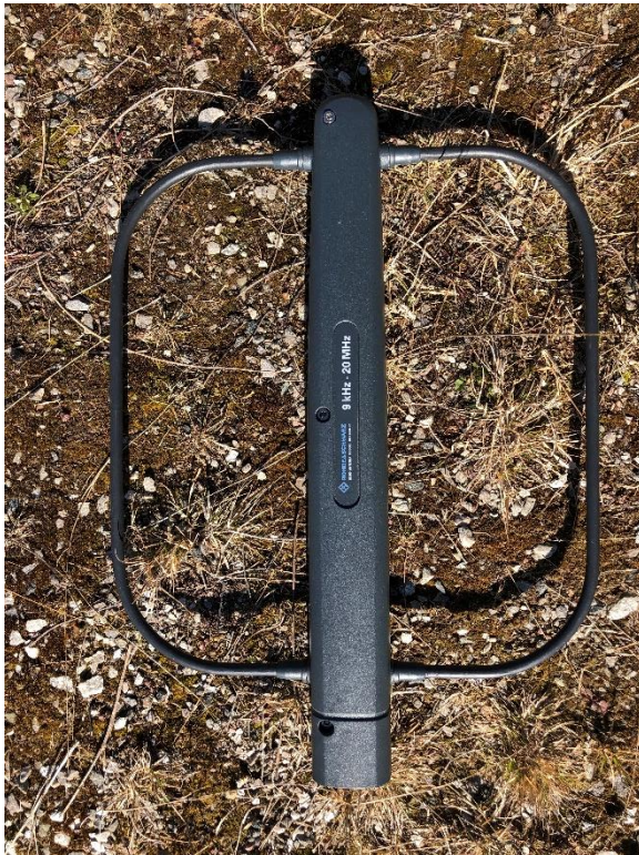
Figur 39: Rohde & Schwarz HE300 antenn 9 kHz - 20 MHz.
