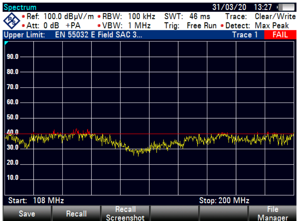
Figur 16: Referensmätning av signalmiljö 108-200 MHz.
