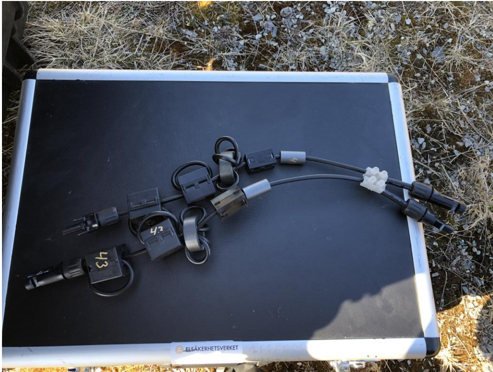
Figur 14: Kabel med ferriter av typen Fair-Rite material 43.
