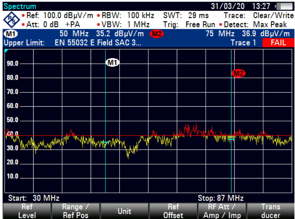
Figur 15: Referensmätning av signalmiljö 30-87 MHz.
