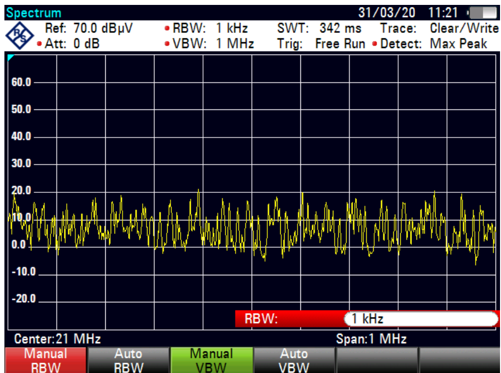
Figur 31: Ledningsbunden emission på växelriktarens likströmskablage.
