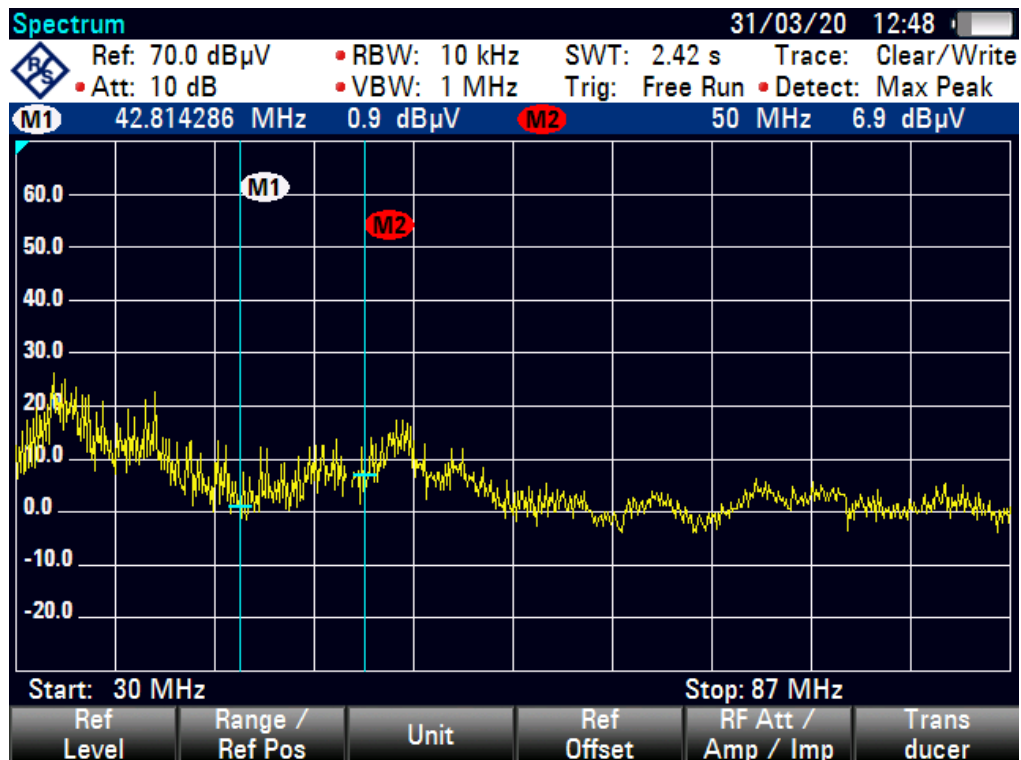
Figur 33: Ledningsbunden emission på växelriktarens likströmskablage med ferriter.
