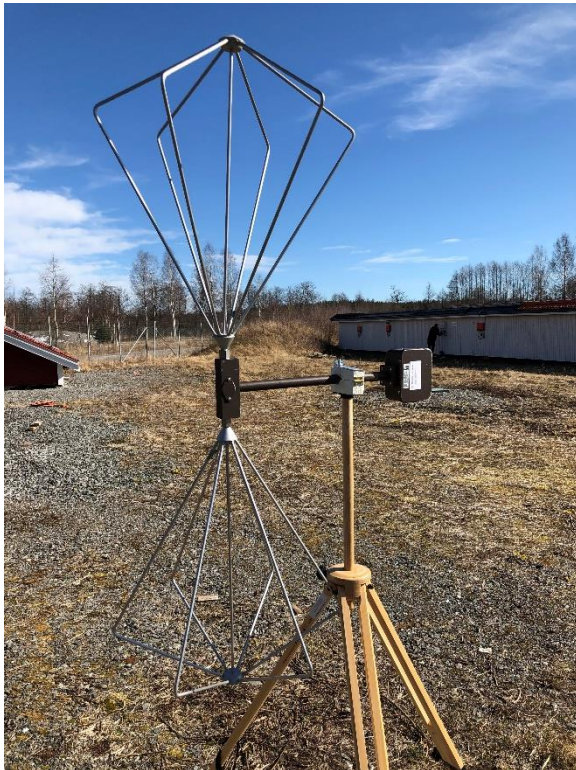
Figur 35: Bikonantenn 30 – 200 MHz. Emco 3104 s/n: 2418 kal: 2019-12-04
