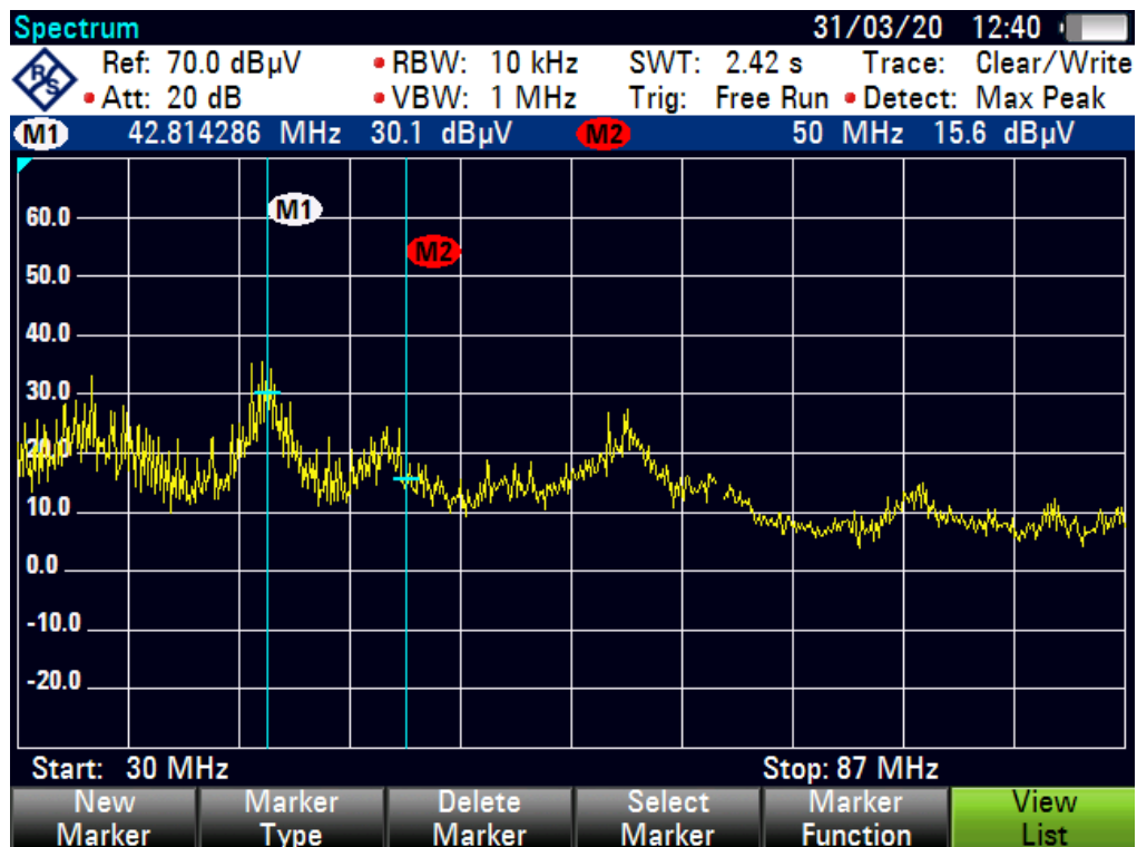
Figur 34: Ledningsbunden emission på växelriktarens likströmskablage utan ferriter.
